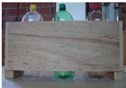
Figura 06 – Vista frontal das fôrmas em madeira do bloco “T”.
