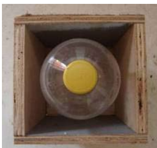
Figura 08 – Vista superior das fôrmas do meio bloco.
