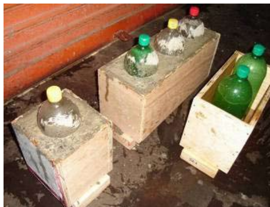
Figura 09 – Vista lateral das fôrmas com concreto moldadas.
