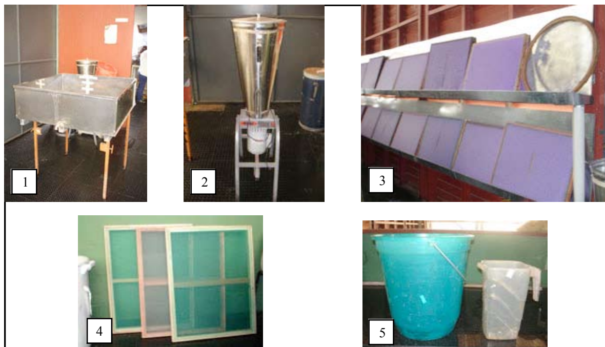
Figura 1 – Cuba (1), liquidificador industrial (2), suporte de telas (3), telas (4), recipientes para molho e medida (5).
