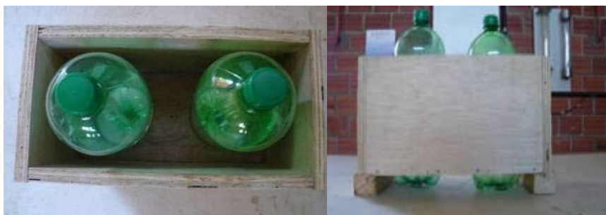
Figura 07 – vista superior das fôrmas em madeira do bloco inteiro.
