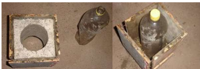
Figura 10 – Desmoldagem dos blocos.
